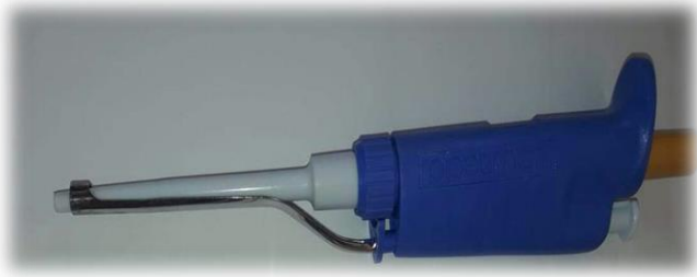
Figure 38 : Micropipette « eppendorf » à volume variable (10-1000 \mu L) (photo originale)
