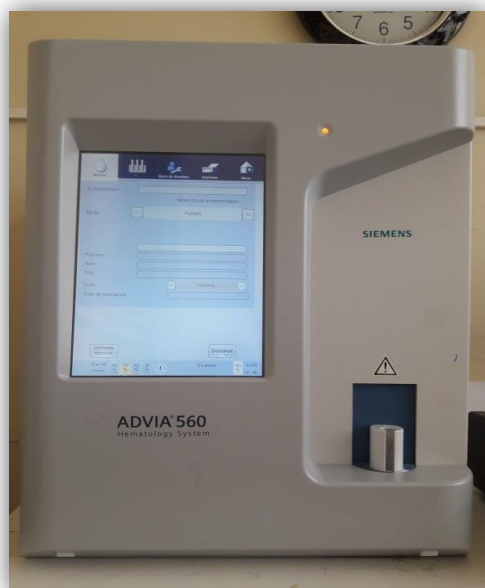
Figure 43 : Automate de l’FNS «ADIVIA 560» (photo originale)
