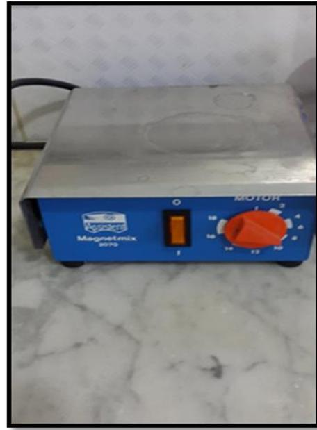
**Figure 27** : Agitateur magnétique
