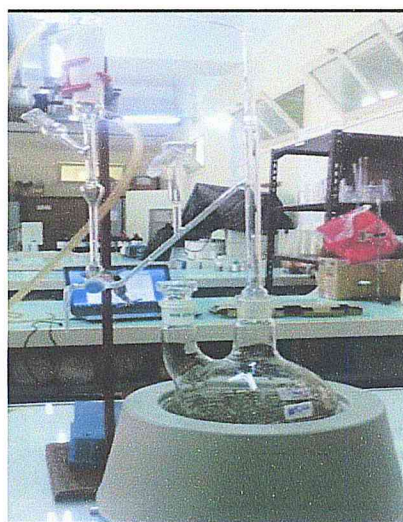
Figure 10: montage de l'hydrodistillation «Clevenger»
