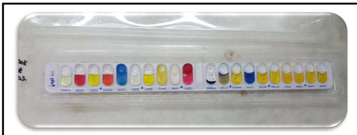
Figure n°41 : Profil biochimique de l'espèce d' Enterobacteriaceae trouvée sur la galerie API 20 E
