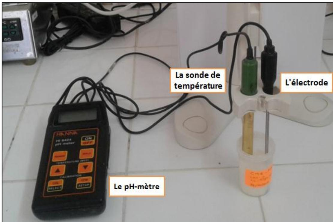
Photo 11 : pH-mètre (photo prise au laboratoire).
