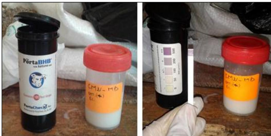
**Photo 09 : Bandelettes utilisées pour la détection des corps cétoniques dans le lait (photos prises à la ferme Bayou à Bouarfa).**
