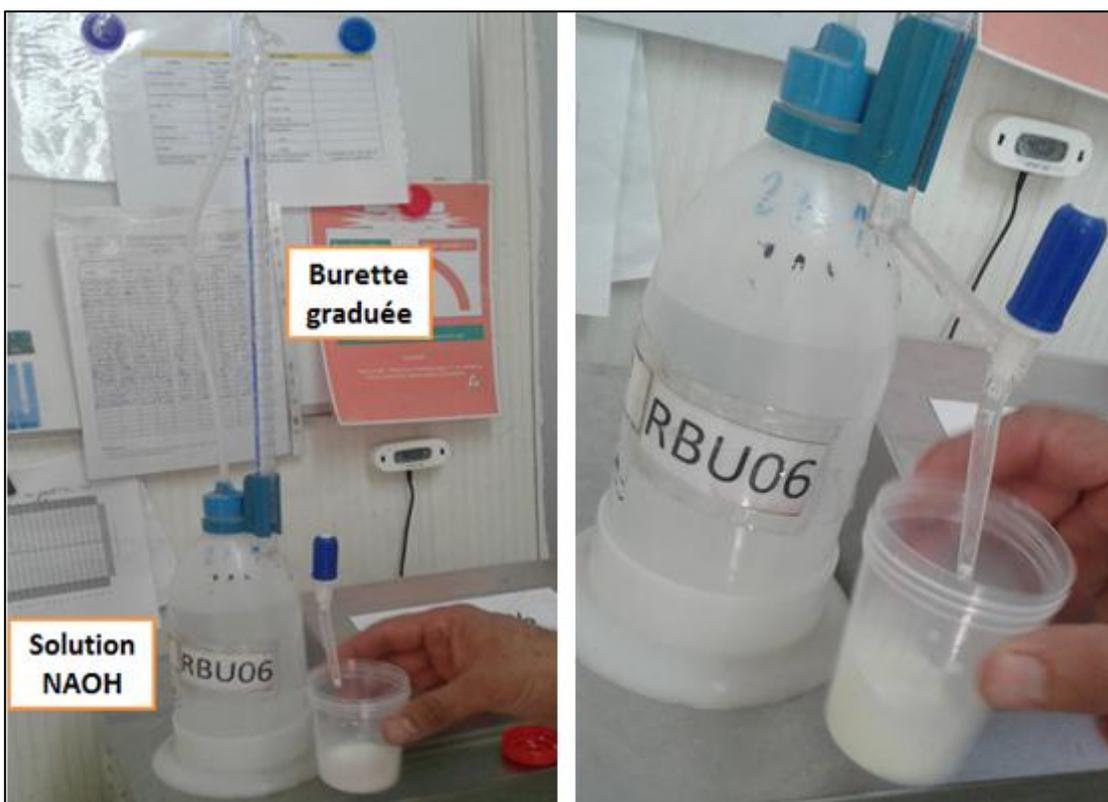
Photo 13 : Titrage de l'acidité du lait par l'Hydroxyde de Sodium (NAOH) (photos prises au laboratoire).
