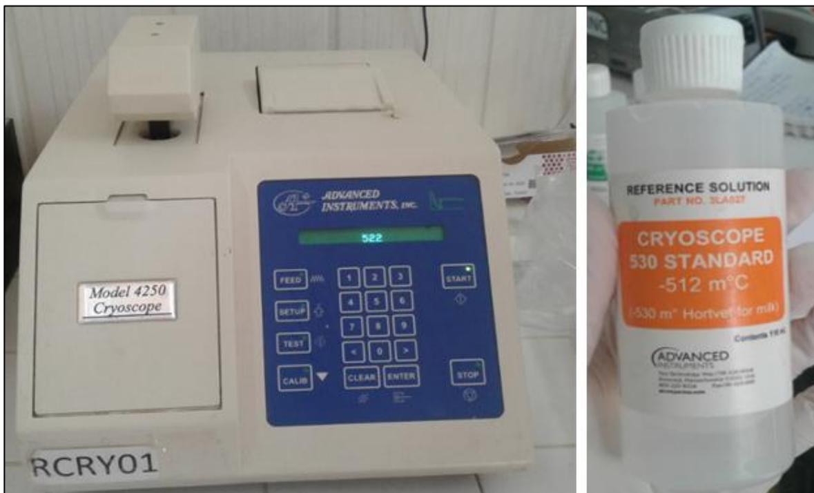
**Photo 10 : Cryoscope 4250 Model et la solution de référence utilisée pour l'étalonnage de cryoscope (photos prises au laboratoire).**
