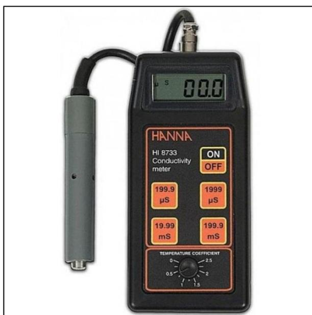
Figure 05 : Un conductimètre (Measurecurrent).
