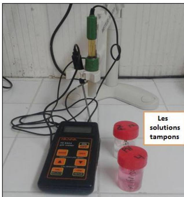
Photo 12 : Les deux solutions tampons (pH=7, pH=4) (photo prise au laboratoire).
