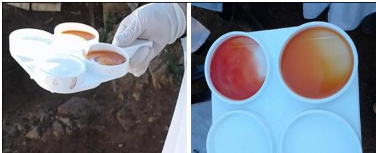
**Photo 07 : Mouvements circulaires sur le plan horizontal (photos prises à la ferme Bayou à Bouarfa).**
