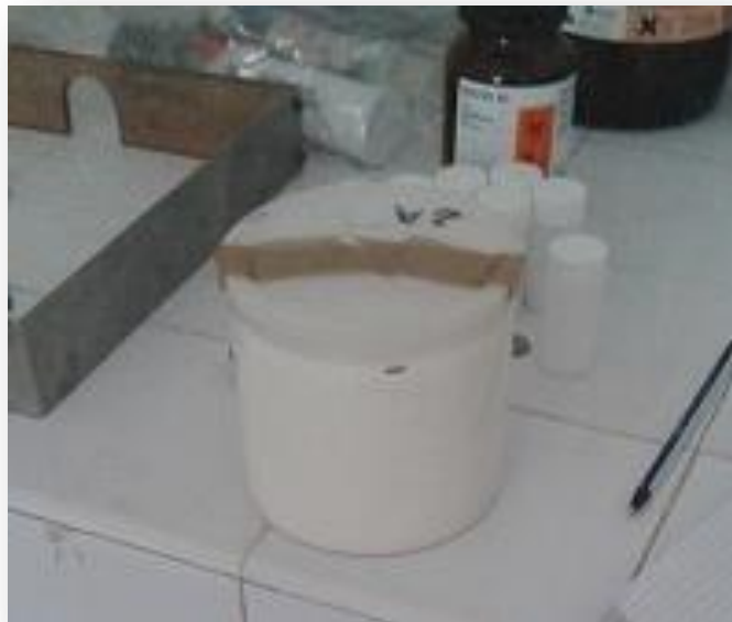
Figure 14 : 500ml du lait de chamelle dans un porte échantillon Marinelli.
