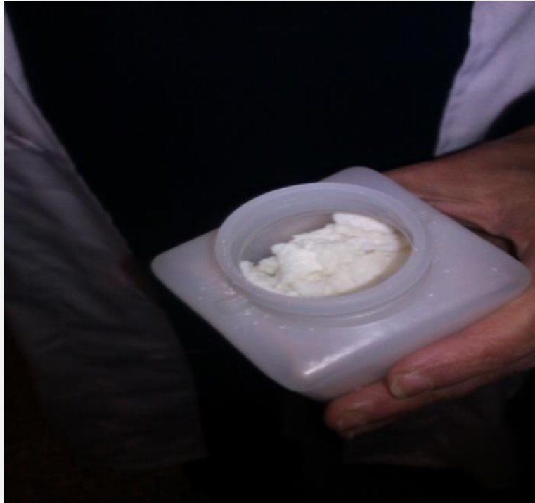
Figure 12 : lait de chamelle lyophilisé et stocké dans un porte échantillon.
