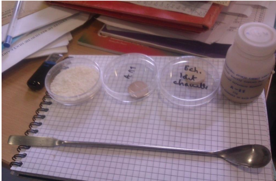
Figure 15: conditionnement des échantillons sous forme de pastilles dans de boîtes de pétri (photograph).
