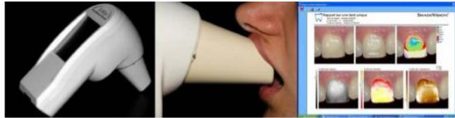
**Figure 17 : Le colorimètre Sgade Vision de X Riteet la fiche de rapport d'analyse destinée au laboratoire.(21)**
