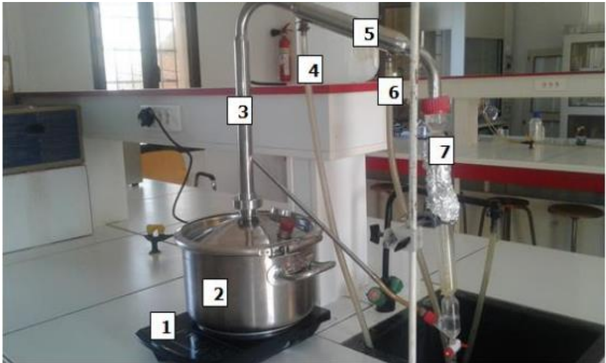
Figure 10: Montage d'entraînement à la vapeur d'eau. 1: plaque chauffante, 2: cocotte-minute, 3: condensateur, 4: sortie de l'eau, 5: réfrigérant, 6: entrée de l'eau et 7: tube gradué.
