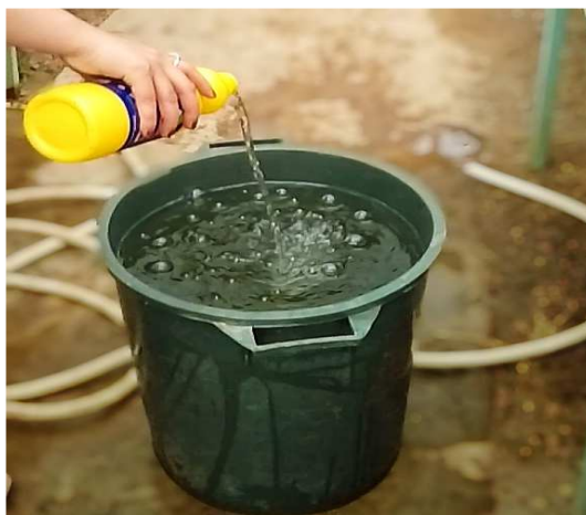
Figure N°13 : Dilution de l'eau de javel pour le lavage du gravier
