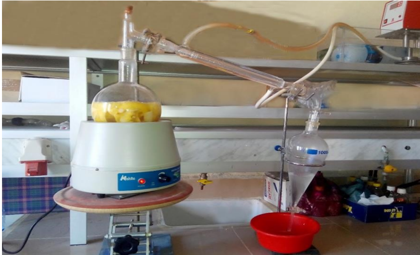
Figure 25 : Montage d'hydrodistillation de type Clevenger (photo personnelle, 2020)
