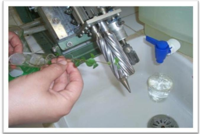
**Figure 2.19:** Broyage des échantillons à l'aide d'un broyeur à rouleaux.
