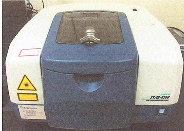
Figure II.1. Spectrophotomètre JASCO FT/IR-4100.
