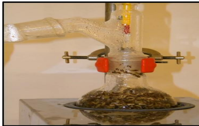
La méthode d'extraction par hydrodistillation (type de clevenger)
