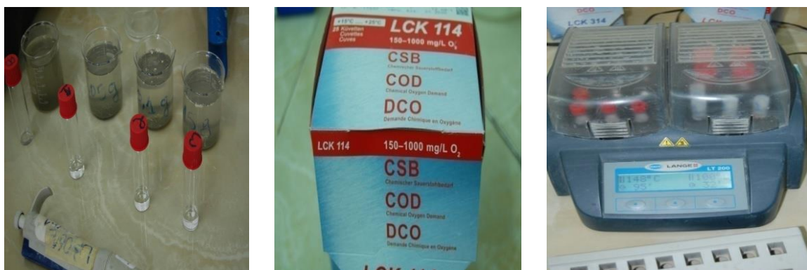
Figure 21: Réactifs et thermostat avec spectrophotomètre utilisés pour analyse de DCO (SEAAL, 2018)
