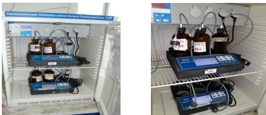
Figure 24: BDO-mètre BODTrak utilisé dans la STEP d' Ain benian (SEAAL, 2018).
