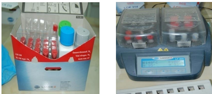
Figure 25: Réactif et thermostat HACH LT200 avec spectrophotomètre (DR2800) utilisés pour l'analyse de l'azote total dans la STEP de Baraki (SEAAL, 2018).
