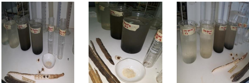
Figure 20: Traitement d'eaux usées avec la dose ( X_1 = 0,5 g/l) STEP d'Ain benian.
