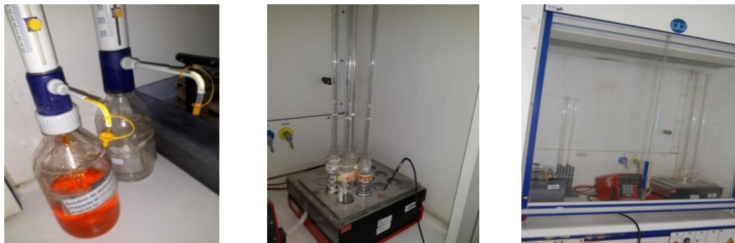
Figure 22: Réactifs et incubateur DCO utilisé dans la STEP d'Ain benian (SEAAL, 2018).
