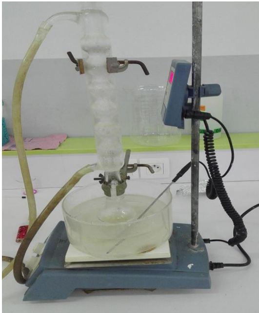
L'hydrolyse des esters par chauffage
