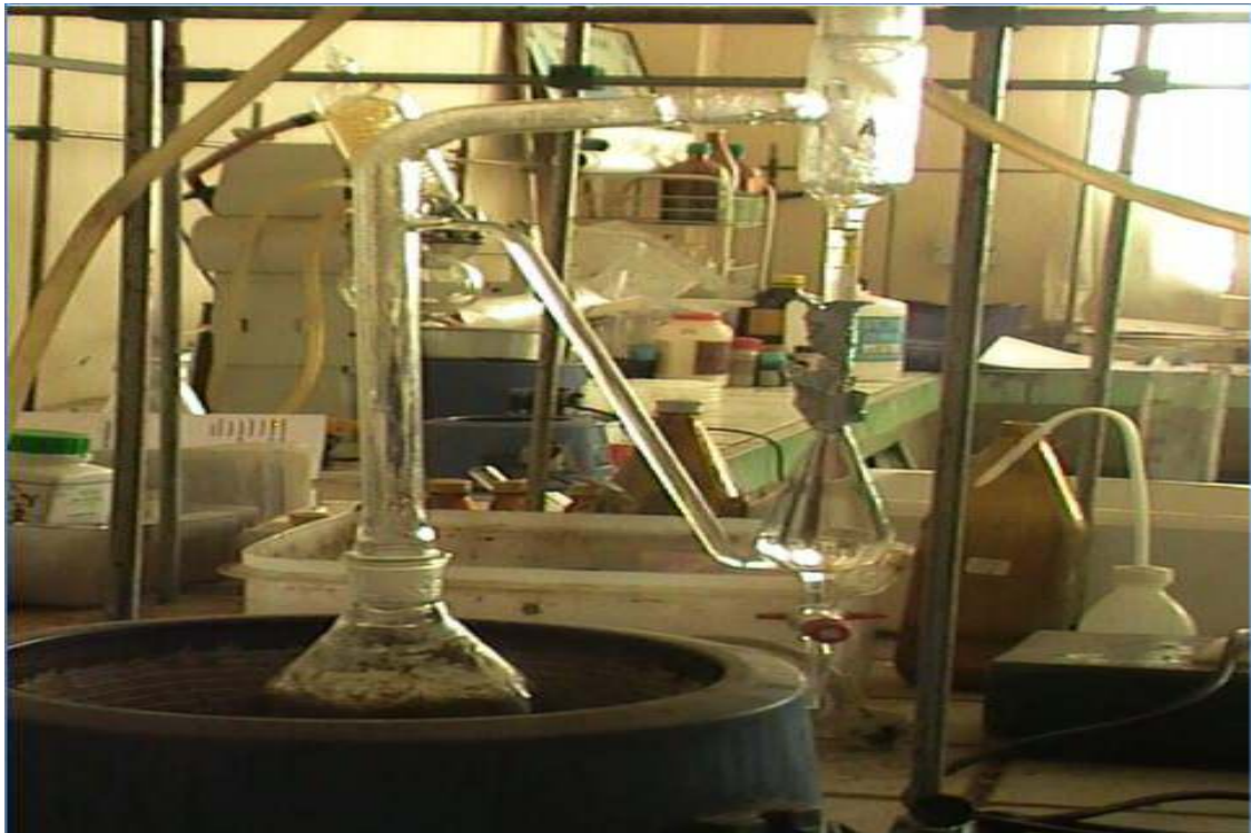
Figure 9 : Extraction des huiles essentielles par la méthode Clevenger
