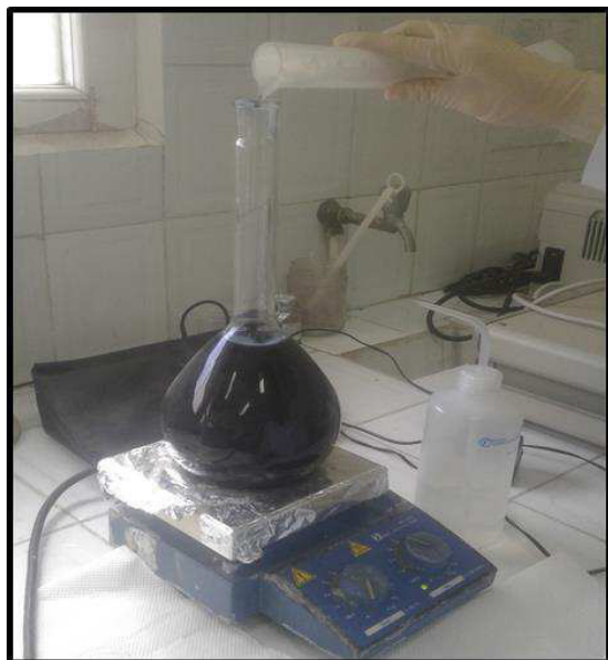
Figure 03 : Préparation de réactif Bradford (INRAA/2019)
