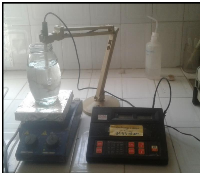
Figure 04: Préparation de tampon d'extraction des Protéines (ph= 8.1) (INRAA/2019)
