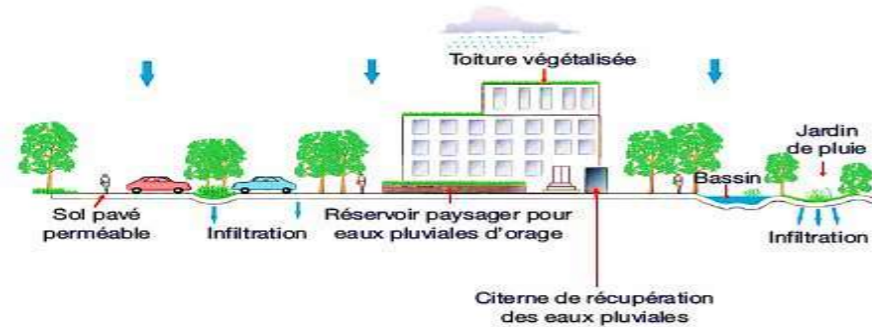
Figure 65: représentation de la récupération des eaux pluviales
