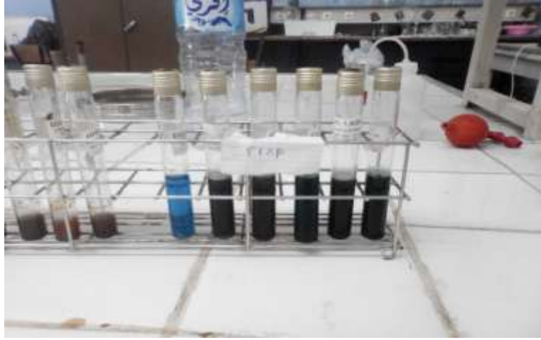
Figure 22 : Réduction du chlorure ferrique
