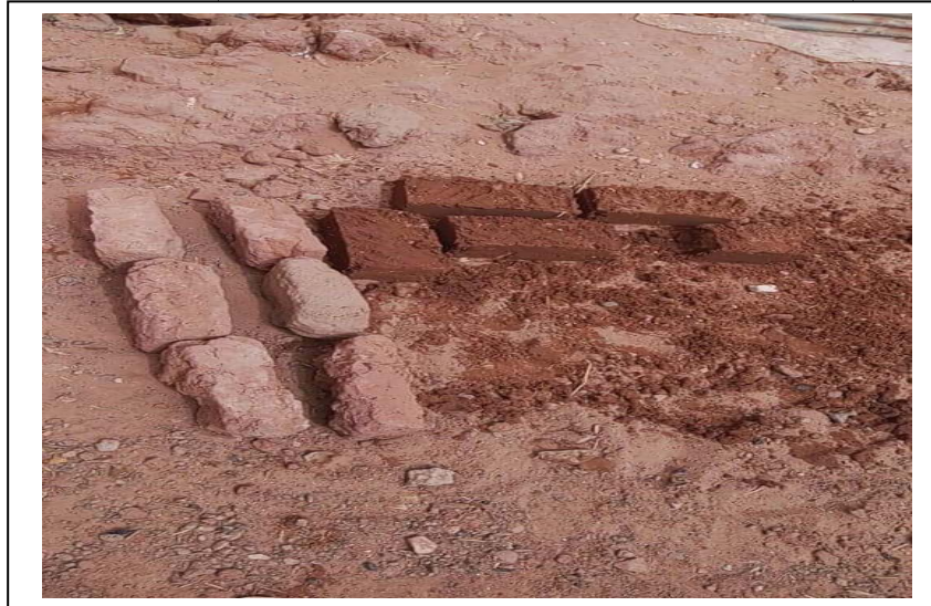
Figure 3-5 séchage de l'adobe
