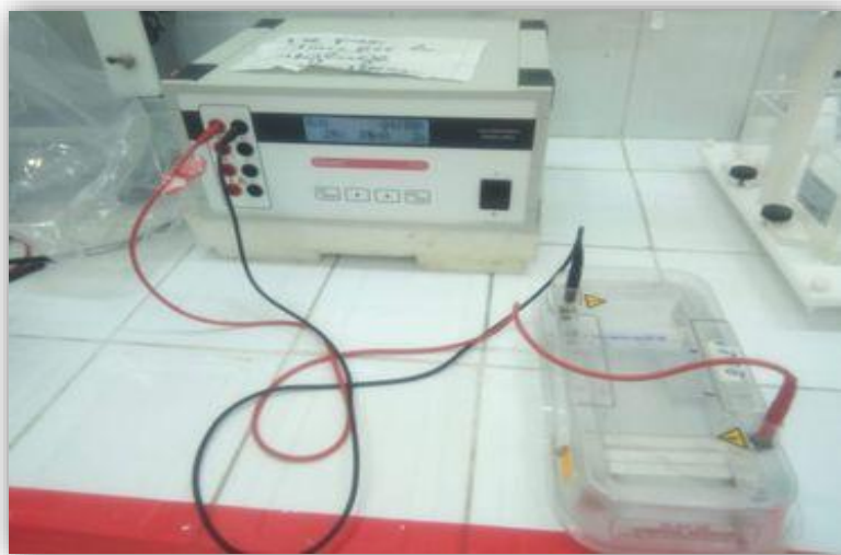
Fig 20 : La migration sur gel d'agarose sous un voltage de 60 V.
