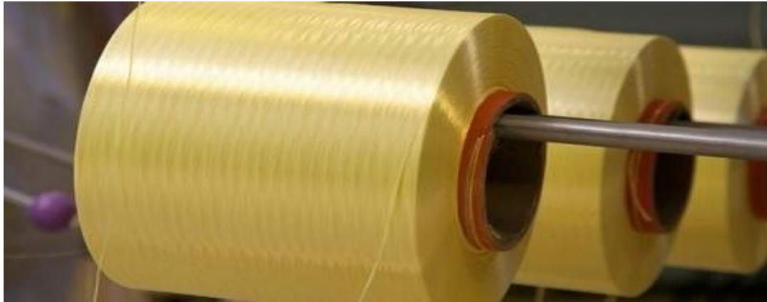
Fig (IV.3). Aramid (Kevlar) fiber
