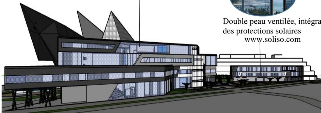
**Figure 171 :** La façade sud-ouest mixte : simple peau avec brise-soleil et double peau ventilée, intégrant des protections solaires de type store vénitien à lames aluminium, à commande électrique.
