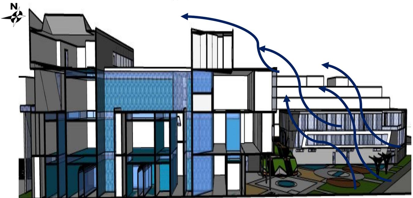
Figure 156 : Solution architecturale contre les vents forts d'hiver soufflent par l'ouest
