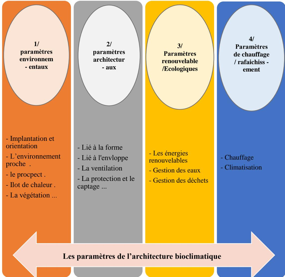
Figure 25 : Les différents paramètres de l'architecture bioclimatique
