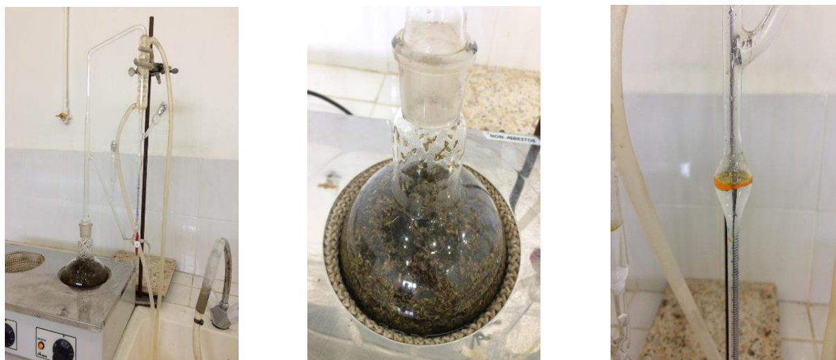
Figure 19 : Hydro distillation par Clévenger méthode employé pour l'extraction de l'huile essentielle du thym, dispositif, phase ébullition de l'eau et observation de l'huile essentielle flottante ( Originale ).
