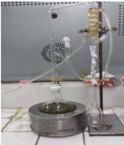
**Figure 8** : Dispositif de l'hydro distillation.
