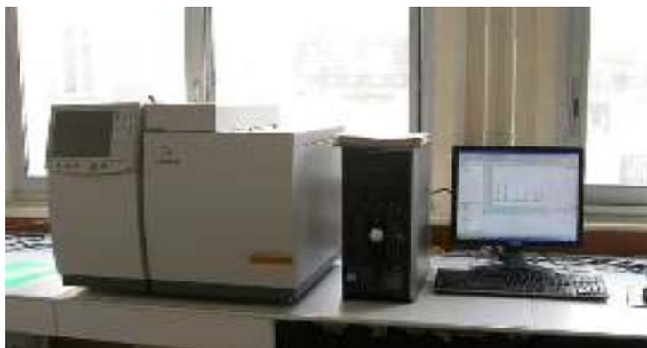
**Figure 12 : Appareillage du chromatographe en phase gazeuse utilisé**
