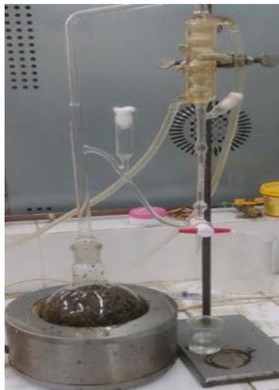
**Figure 13 :** Hydro-distillateur
