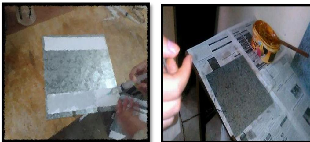
**Figure 17:** Disposition de lanières en papier buvard portant le traitement, sur les langes graissées.
