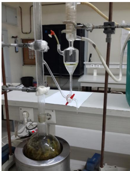
Figure.3 : Montage de l'appareil Clevenger du procédé de l'hydrodistillation (Originale 2018).
