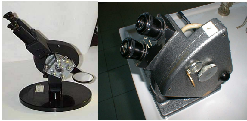
Figure annexe I 6 Réfractomètre ABBE
