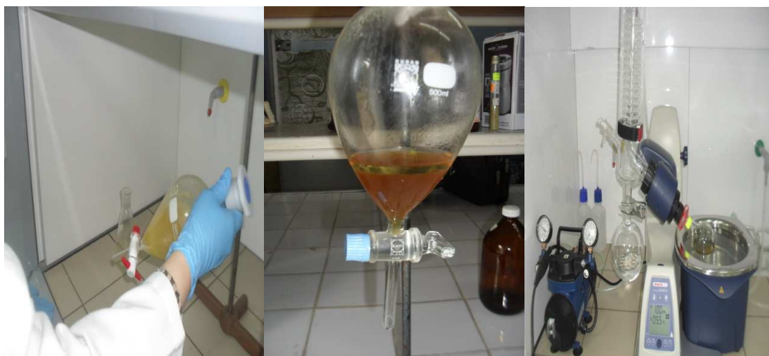
Figure 6 : a- Affrontement et agitation b- Décantation de 2 phases c- Evaporation à sec à 40°C (Original, 2018).
