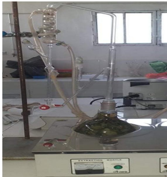
Figure 10 : montage d'hydro-distillation du type clenvenger
