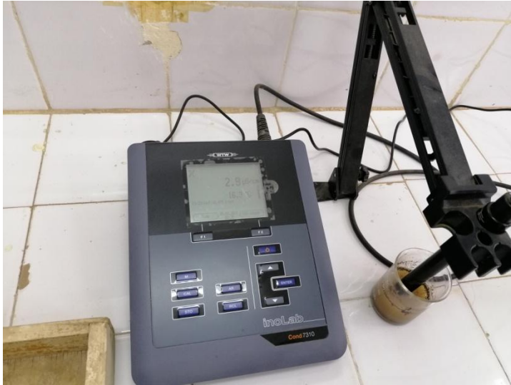
Figure 25 : Analyse de la conductivité électrique par le conductivimètre (original, 2020)
