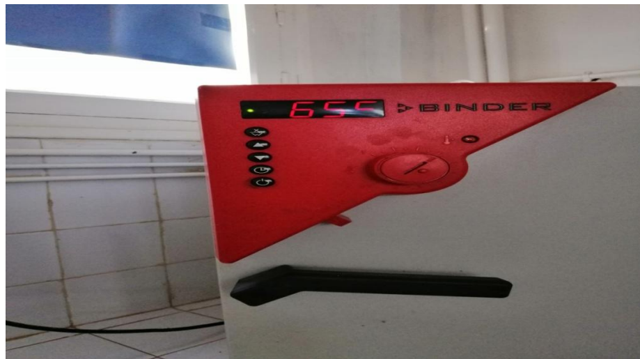
Figure 16 : Le séchage de la litière à l'étuve ( original,2020 )
