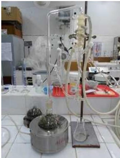
**Figure 10 : Hydrodistillateur Clevenger.**
