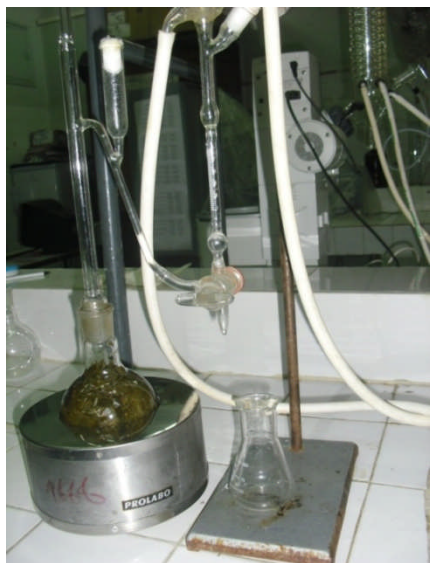
Figure 12 : Dispositif d'hydrodistillation de type clevenger
