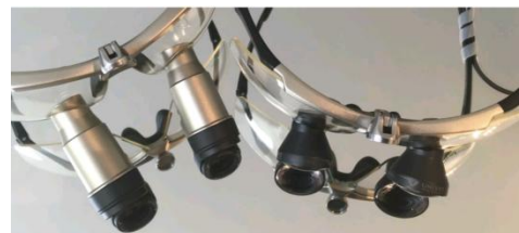
FIG .N° 180: Loupes binoculaires (photo duDr Moll). A gauche : loupes de Kepler (4x). A droite : Galiléenne (2.5x).
