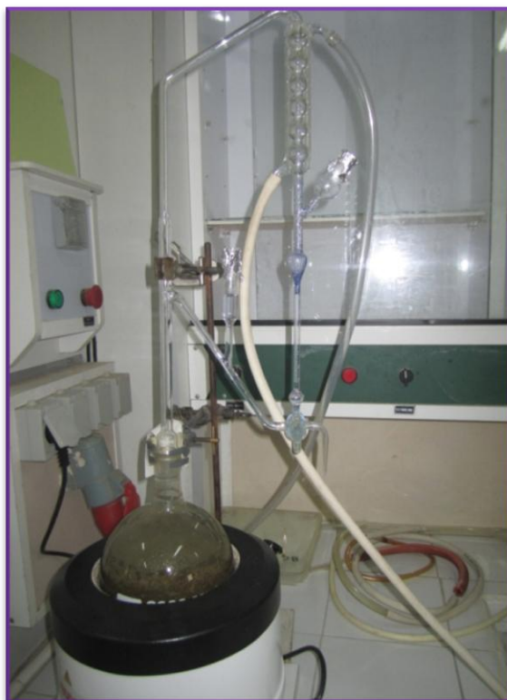
Figure 23 : obtention des HE par hydrodistillation montage Clevenger.
