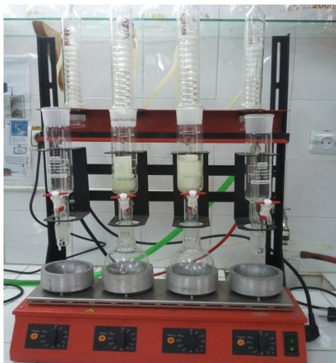
**Figure 21** ♦ appareil de Soxhlet
