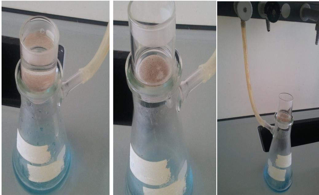
**Figure 23** ♦ décantation du sur creuset de verre filtré placer sur une fiole à vide (Originale, 2013)
