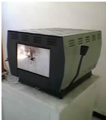
**Figure 24** ♦ four à moufle. **Figure 25** ♦ bain de sable.
