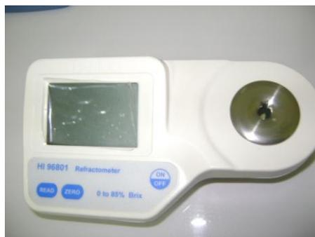
**Figure n°21:** le réfractomètre utilisé pour le degré Brix
