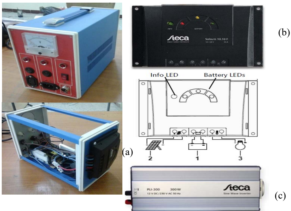
Figure III.9: boîtier électrique (a), régulateur de charge (b), convertisseur DC/AC (c) (29)
