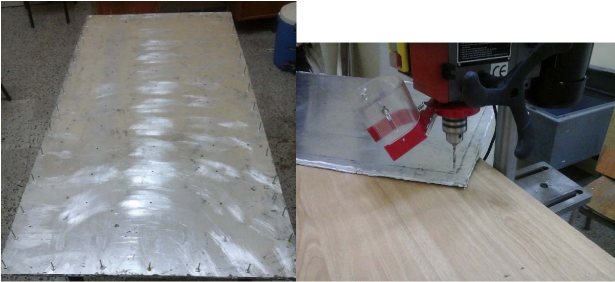
Figure IV.2: perçage et rivetage du capteur thermique
