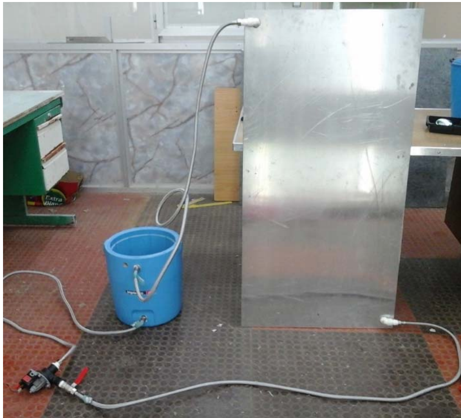
Figure IV.1: 1er test d'étanchéité du capteur solaire thermique
