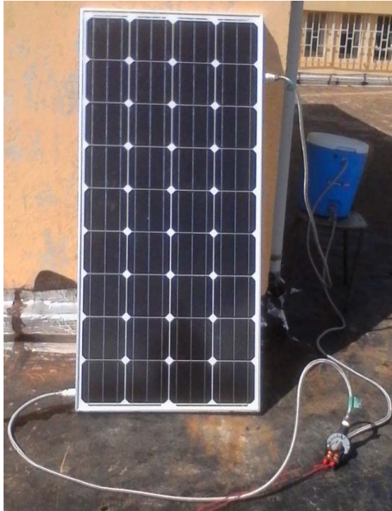
Figure III.16: test du capteur PV/THERM sur la terrasse du département
