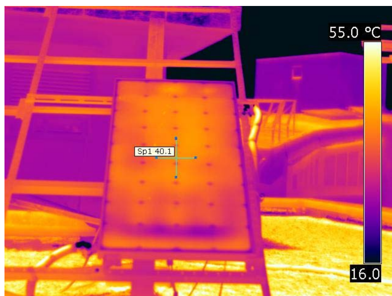
Figure IV.9: image thermographique du PV/THERM après 10min de refroidissement
