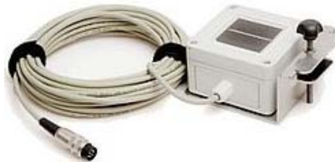
Figure III.13:PVPM1000C40 avec son pyromètre de référence
