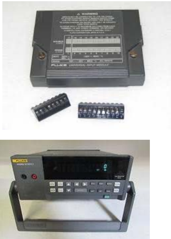
Figure III.10: module d'acquisition HYDRA (a droite) avec son circuit (a gauche)
