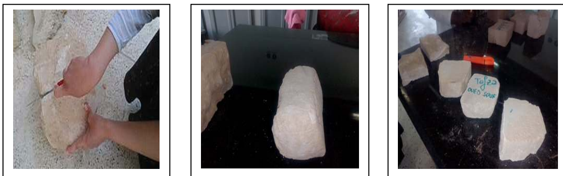
Figure 2.19: Les étapes de découpage de la pierre de « Tafza »
