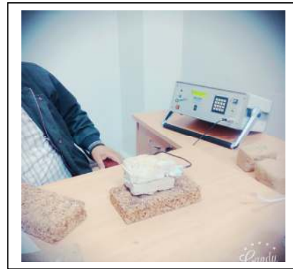
Figure 2.22 : CT mètre en mode de mesure de « la Rose de Sable »
