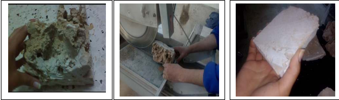
Figure 2.20 : Les étapes de découpage de la « Rose de Sable »
