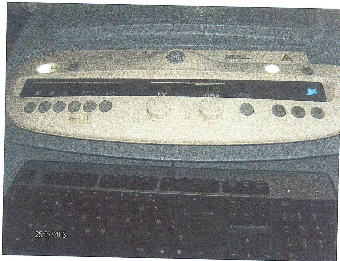
Figure (IV.3) : Pupitre de commande pour choisir le mode et les paramètres d'expositions
