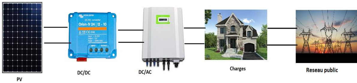
Figure III.1 : Système PV étudié (système PV On-Grid)
