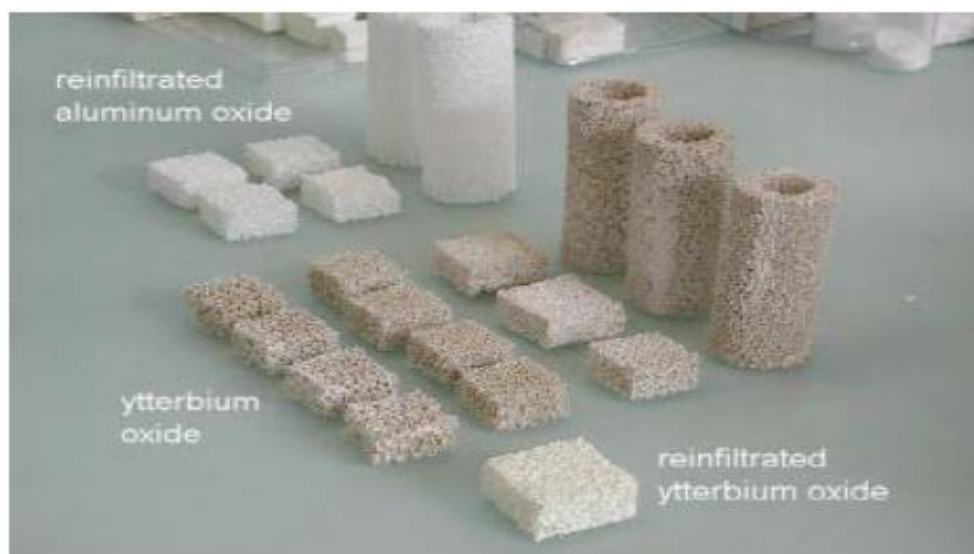
Figure 1.5 : Des échantillons céramiques et quelques tubes des émetteurs céramiques. [9]
