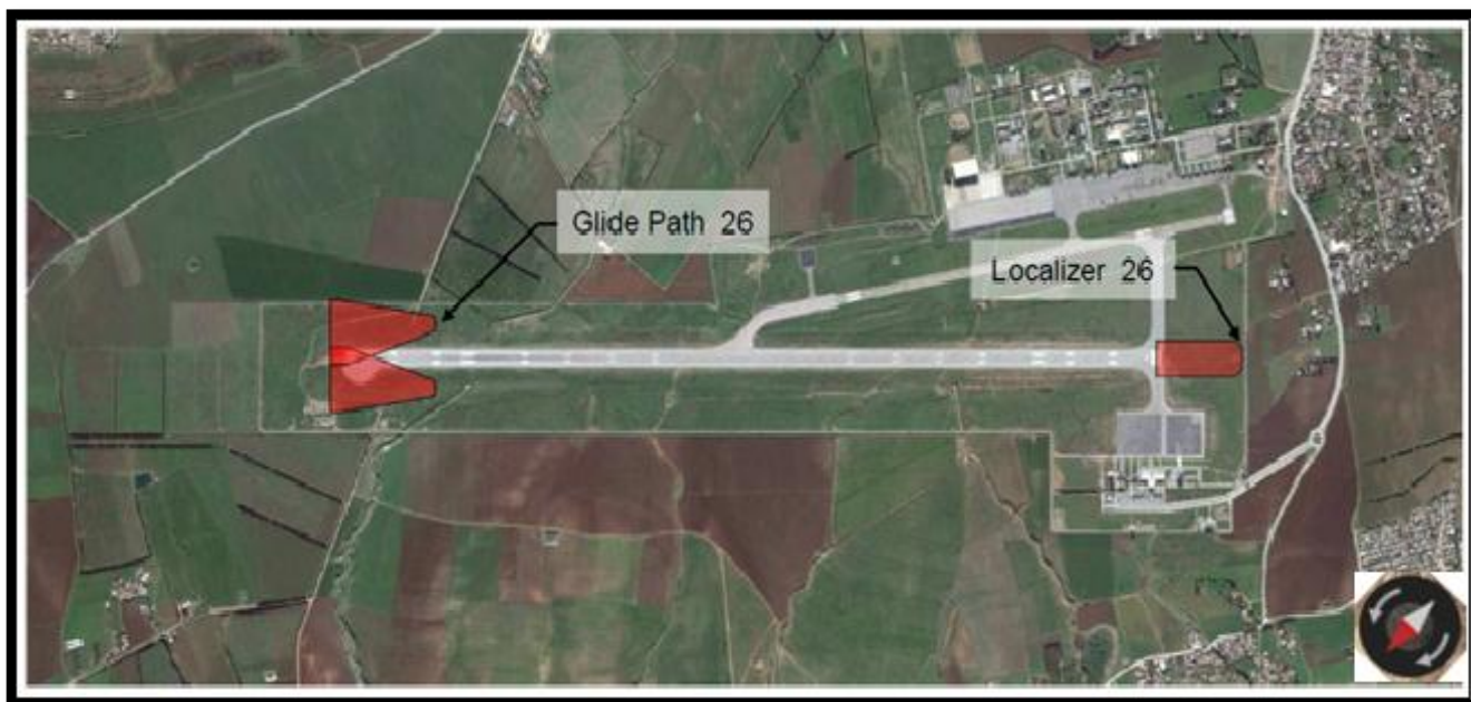
Figure III.15 : Disposition de l'aéroport [13]
