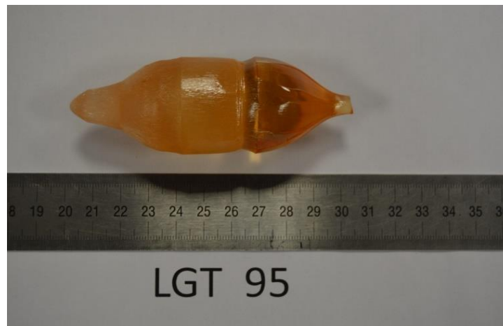
Figure III.2 : photo du cristal langatate élaboré par la technique Czochralski.
