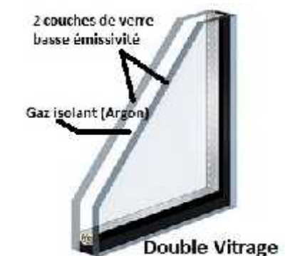
Figure 6.48 : la structure du double vitrage Source : conseils-thermiques.org
