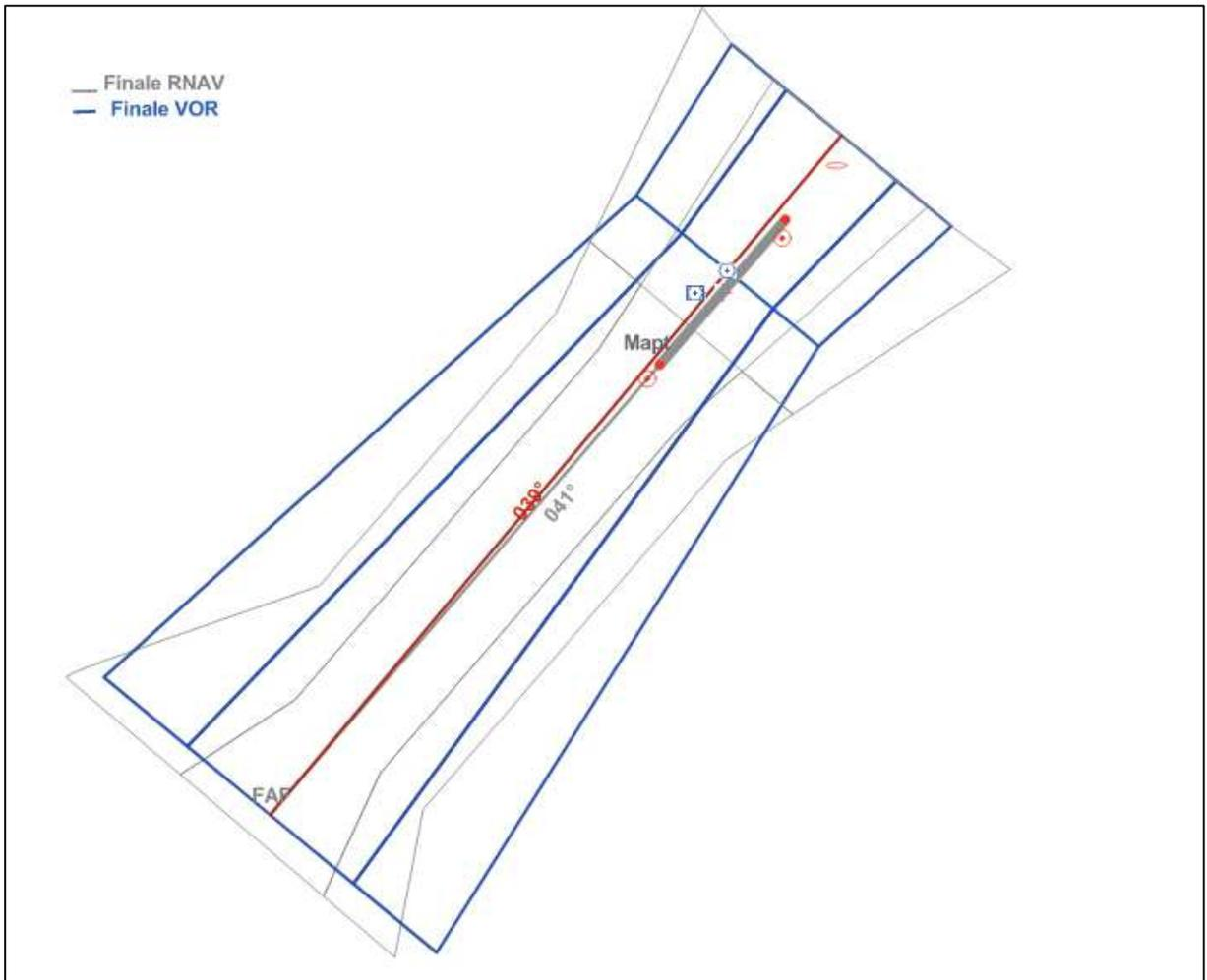
**Figure 3.11** : superposition des aires de protections d'une approche finale VOR et d'une approche finale RNP APCH []
