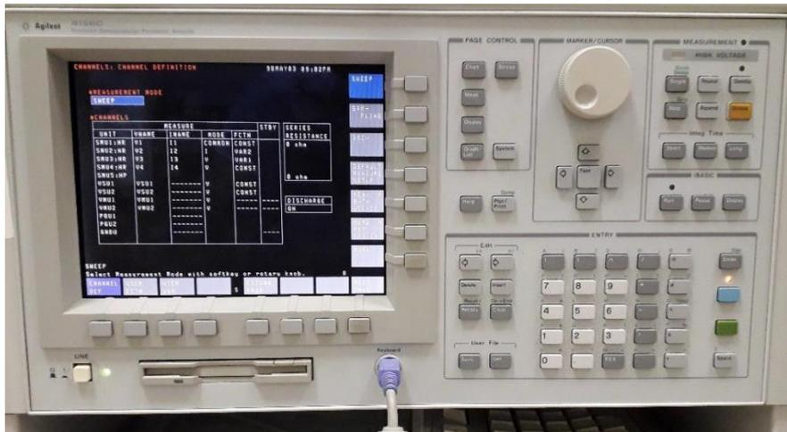
**Figure 2.5 :** Analyseur de paramètres semi-conducteurs, **Agilent 4156C.**
