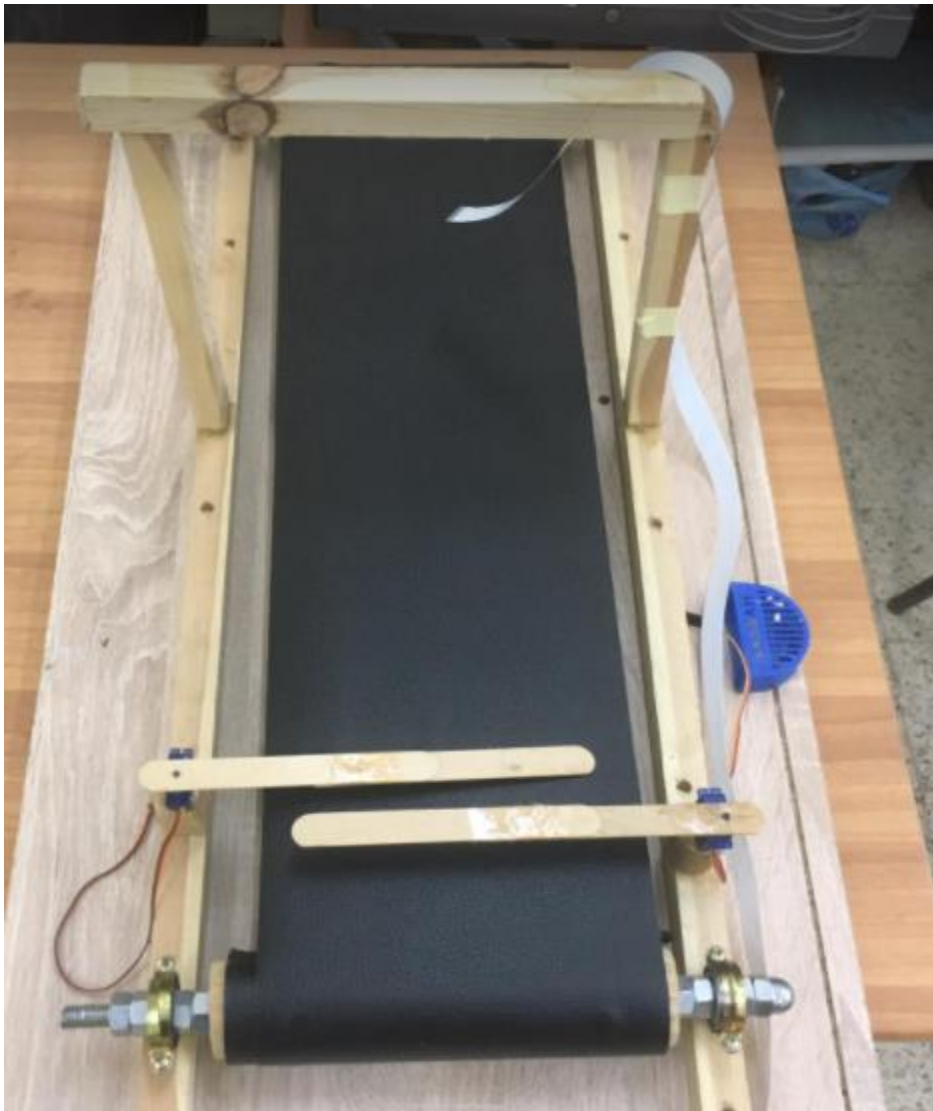
Figure 4.6.1 : notre convoyeur avec l'emplacement des servo moteurs
