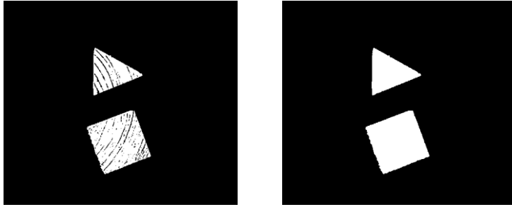
Figure 3.12 : Prétraitement de l'image acquise par caméra ; (a) Image binarisée. (d) Résultat d'ouverture suivi de fermeture avec un élément structurant disque de taille 7x7.
