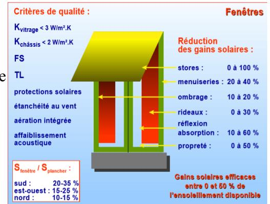
Fig.44 : choix de composant et identification des facteurs intervenants dans la thermique de la fenêtre source : traité d'architecture et d'urbanisme bioclimatiques.
